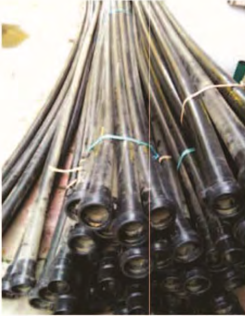
స్ప్రింకల్ పైపులు (Sprinkler Pipes)
